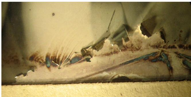
Figura 2.3. Delaminación de la plata en el borde de una placa daguerriana. Detalle fotografiado a través de una lente de aumentos.
