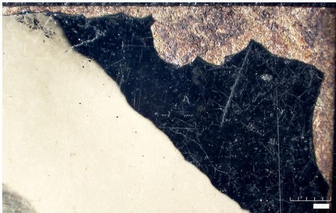
Figura 2.6. La esquina superior derecha de este ferrotipo presenta corrosión del soporte y la consecuente pérdida de la capa de colodión (fotomicrografía tomada con un microscopio digital Hirox).
